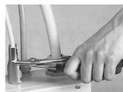
В случае большего количества концевых втулок, помещенных на фланце коробки, следует вставить и уплотнить кабели в концевые втулки постепенно, всегда с одной стороны (напр. слева направо) и начать с втулками в нижнем ряду и затем продолжать с втулками в ряду сразу же над ними.
